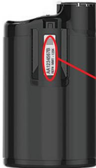
13. Dé la vuelta a la bomba. Compruebe que el número de serie en la parte trasera de la bomba coincide con el número de serie que aparece ahora en la pantalla del **medidor**.
