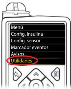
6. **Coja la bomba.** Pulse cualquier botón para encender la pantalla, luego pulse el botón **Menú**. Utilice la flecha hacia abajo para desplazarse hasta **Utilidades**. Pulse el botón **Seleccionar**.
